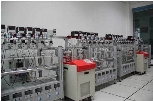
验收专家组成员一致认为，西部环境教育部重点实验室所研发的“AMS 石墨靶合成系统”借鉴了国际同类型实验室的先进技术，结构合理、性能稳定，能够同时进行 24 个靶样的制备，所合成出的石墨经加速器测定束流稳定，系统本底和标准测试结果理想，达到了世界一流水平。
